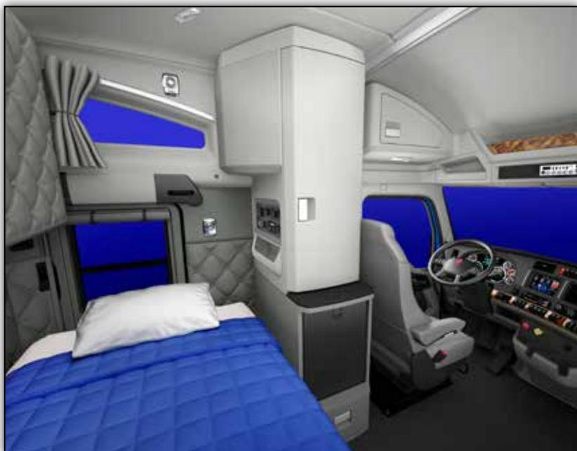
Pour les applications plus discrètes et sensibles au poids, le W990 de Kenworth avec compartiment-couche de 193 cm (76po), à demi-toit, réduit le poids de 45,4 kg(100 lbs). Le vaste compartiment-couche peut être commandé soit avec l'option de système de rangement dans le mur arrière ou encore avec couche supérieure escamotable, afin de répondre à vos besoins personnels.
