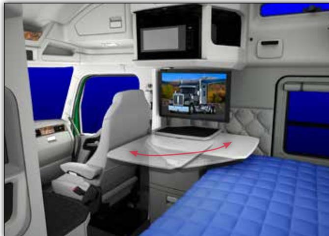
*Afin de maximiser l'espace debout dans le compartiment-couche, il suffit de tirer sur le loquet afin de déverrouiller la table, laquelle peut être pivotée de 90° au-dessus de la couche, vous offrant également un accès facile aux tiroirs du bas.*
