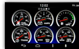
Les jauges virtuelles pré-chargées comprennent la température de l'huile, la température de la transmission, l'indicateur de pression du turbo, l'économie de carburant actuelle et moyenne, le statut du DPF ainsi que le couple du moteur.
