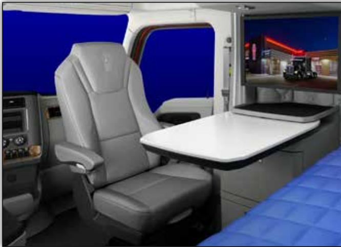
*Le Studio du chauffeur comprend l'ensemble de siège du passager pivotant à 180° et d'une table pivotante, ce qui maximise l'espace vital du chauffeur en combinant la cabine et le compartiment-couche en un vaste studio, permettant au chauffeur de relaxer confortablement dans le siège du passager plutôt que d'être confiné uniquement à l'arrière dans le compartiment-couche.*
