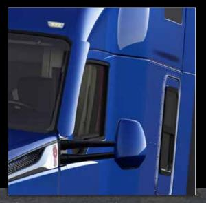
Rétroviseurs Kenworth numériques optionnels et vannes de virage du pilier en A diminuent la résistance et augmentent l'économie de carburant.
