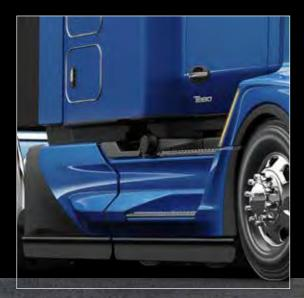
Le design du carénage de châssis est optimisé pour une économie de carburant mais facilite également l'entrée et la sortie.
