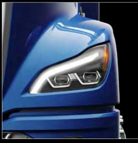
Des phares DEL optionnels avec élément chauffant intégré augmentent la vision de la route par température inclémente et améliorent la visibilité en soirée.
