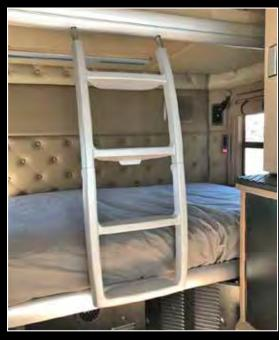
L'échelle de couchette supérieure optionnelle se plie lorsque non utilisée. Ceci fournit aux chauffeurs une façon alternative d'accéder à la couchette supérieure.
