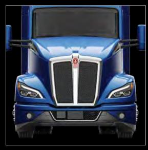
Le design du pare-chocs avant et le déflecteur d'air augmentent la circulation d'air sous et autour du camion tout en maintenant le dégagement au sol.
