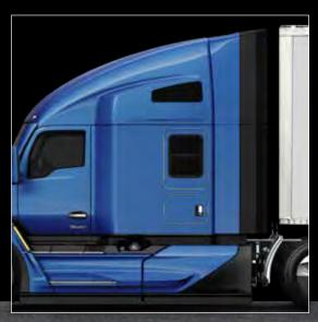
Des extensions de compartiment-couchette de 71 cm de longueur ferment l'écart avec la remorque, augmentant l'économie de carburant. Augmentation du dégagement avec extensions ouvrables optionnelles.
